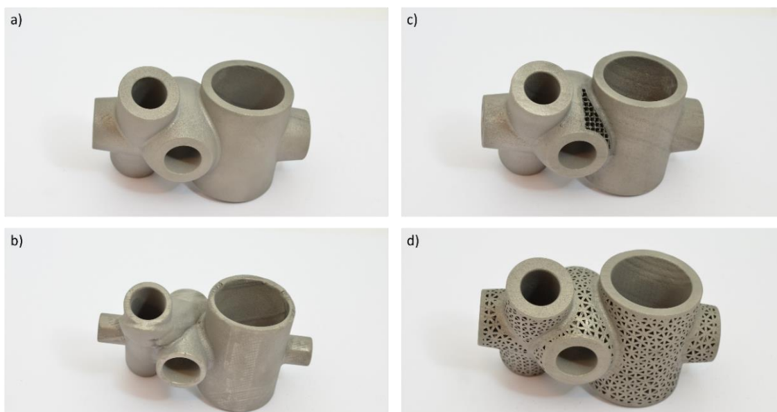
Figur 24 De slutgiltiga komponenterna efter hela tillverkningskedjan a) original b) topologioptimerad c) internt fackverk och d) externt fackverk
