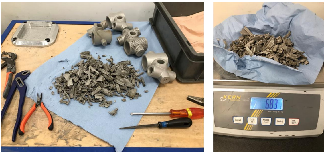
Figur 23 All supportstruktur samlad och vägd efter borttagning
