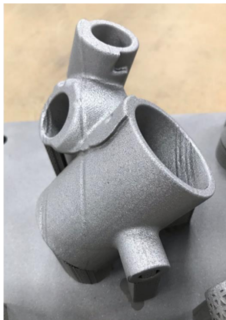
Figur 21 Defekter i komponenterna som uppstod under tillverkningen
