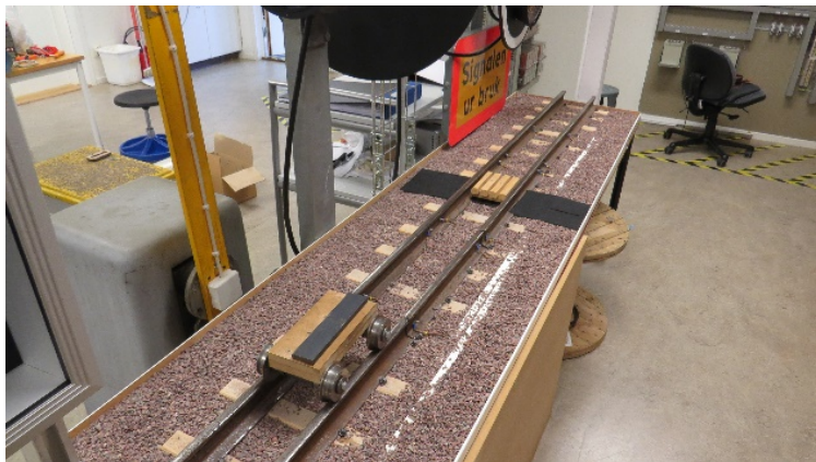
Vägskydd i miniformat inomhus med kopplad bom och vägsignal.
